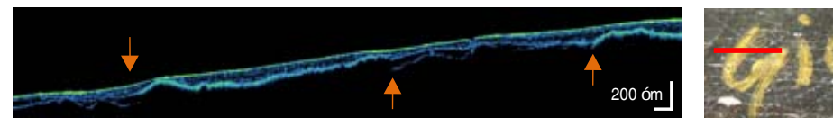
Rys. 1. Tomogram OCT uzyskany w wyniku skanowania obszaru sygnatury w na XIX-wiecznym obrazie olejnym na płótnie („Portret kobiety”, własność prywatna). Strzałki wskazują krawędzie litery „G”, leżącej pomiędzy warstwami werniksu.
